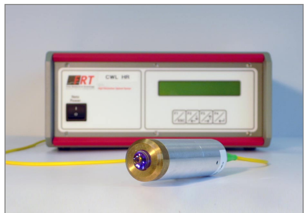
FRT CWL HR Sensor mit optischer Faser und Messelektronik
